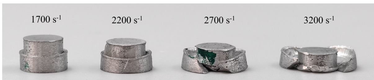
图 11 7A01 中间层复合板经不同载荷高速冲击后的宏观特征
